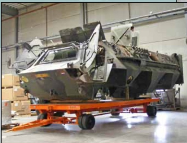
▼ groot onderhoud aan een Fuchs die in Afghanistan is gebruikt
