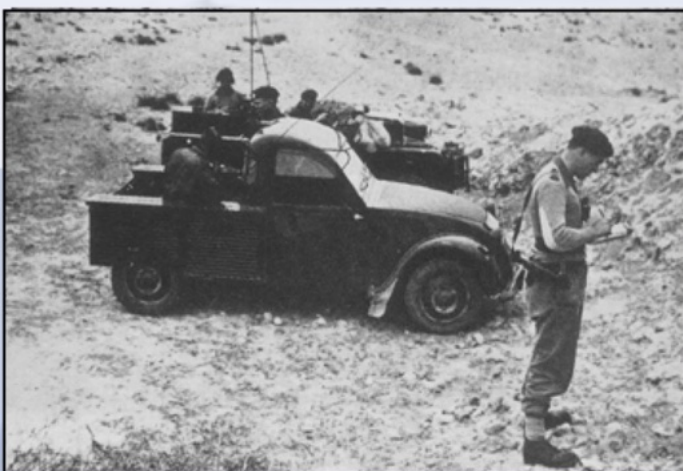
Door zijn soepele vering was de 2CV een prima voertuig voor de kwetsbare radio's
