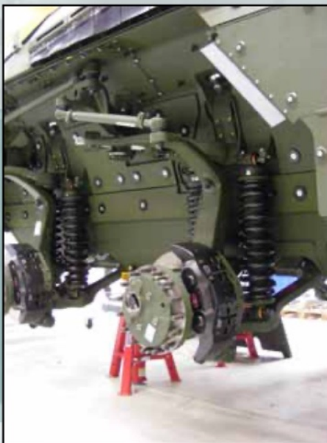
◀ voor de modelbouwers: de ophanging van het eerste en het tweede wiel
