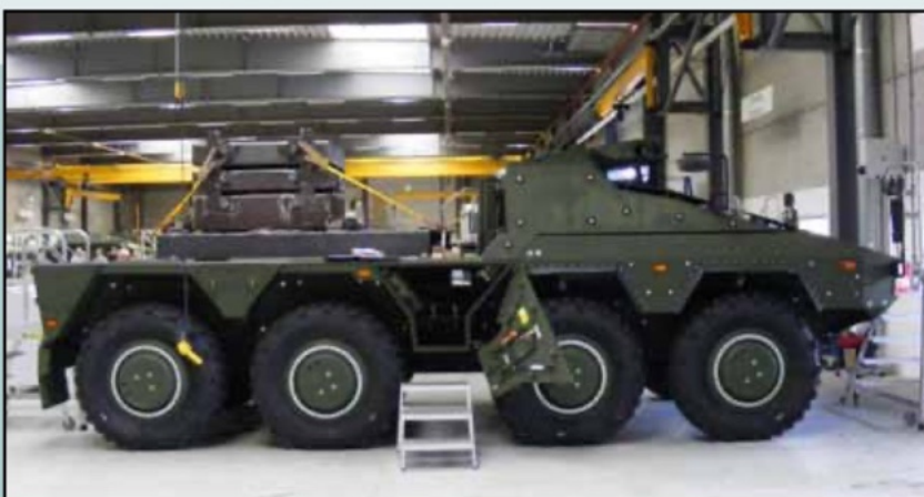
Een drive module waarmee een belastingsproef wordt uitgevoerd.
